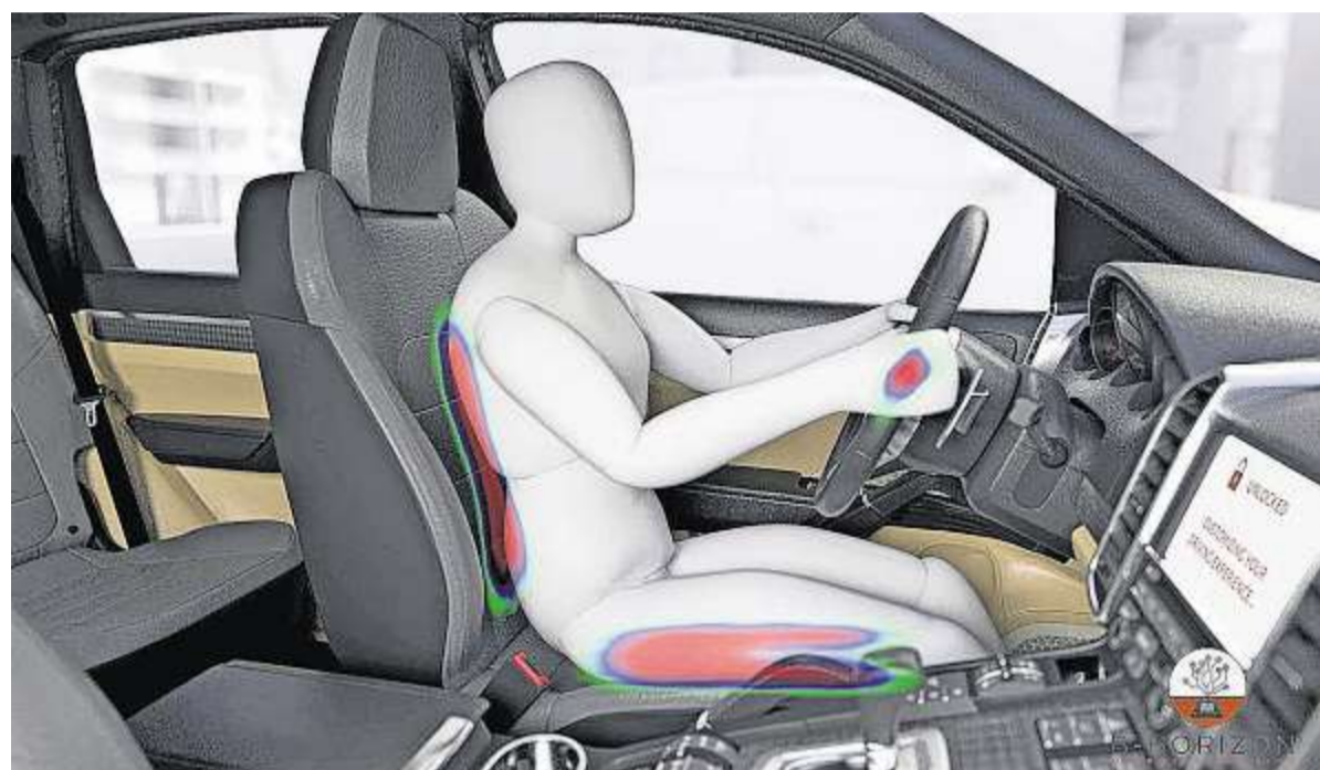
Dank extrem flacher Sensoren im Autositz erkennt das Fahrzeug seinen Besitzer sofort.
